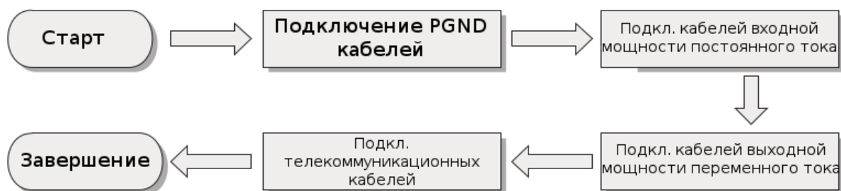
Рисунок 4-1 Блок-схема для подключения проводов к инвертору
