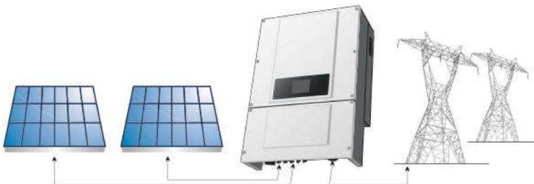
Рисунок 1 Сетевая солнечная электростанция
