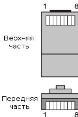
*Рисунок 4-11 Подключение коммуникационных кабелей RS485 (1)*
