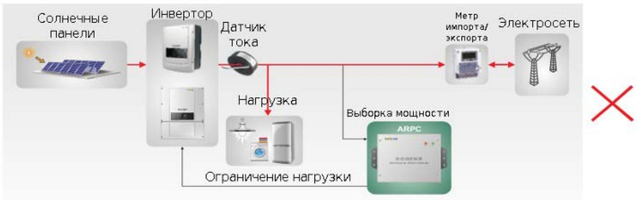
Примечание 3: Не размещайте датчик на проводе N или заземляющий провод.
