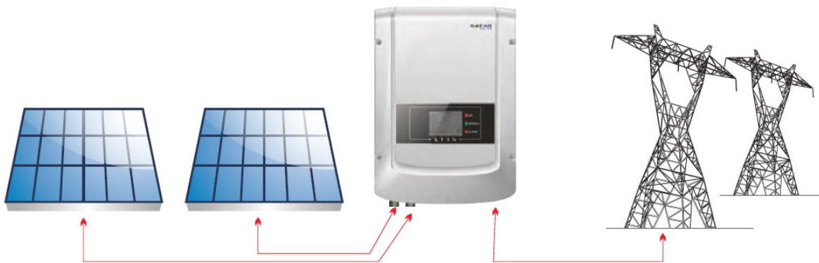
Рисунок 2-1 Фотоэлектрическая установка, связанная с электросетью
