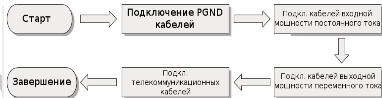
Рисунок 4-1 Блок-схема для подключения проводов к инвертору
