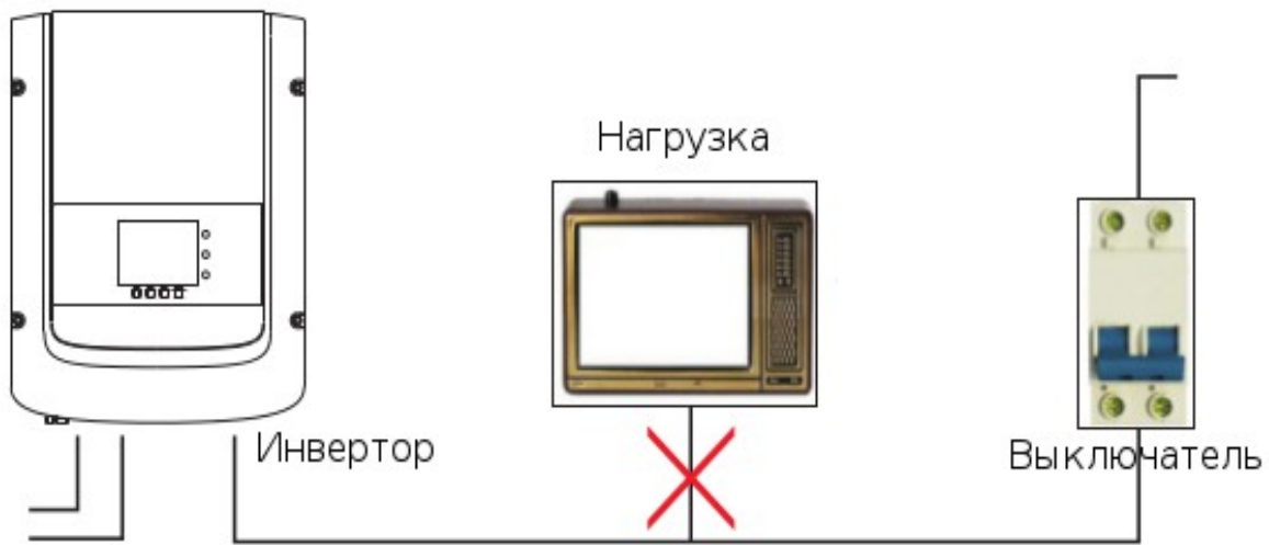
Рисунок 4-9 НЕ допускается: подключение нагрузки между инвертором и выключателем
