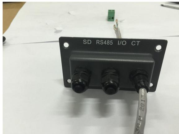
4: Соедините сетевой кабель и разъем подключения к инвертору
