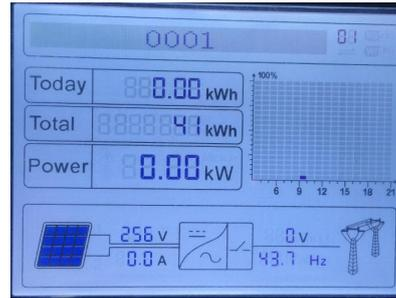
Нажмите "OK" для включения режима запрета генерации, затем, с помощью кнопок "Up" и "Down" введите значение мощности (в кВт), которое инвертор может передавать в сеть. Для подтверждения заданного параметра, нажмите "OK". На экране отобразится надпись "success".
