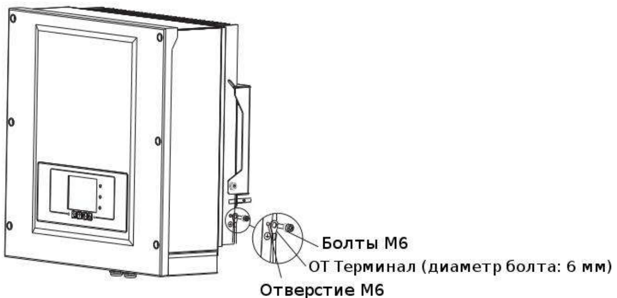
Рисунок 4-2 Состав терминала заземления
