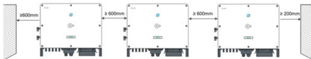
Рис. 18 Зазоры при установке нескольких инверторов
